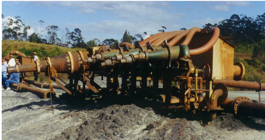
Figura 2.5 – Vista de um conjunto de hidrociclones
